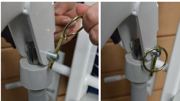
Fig. 2 –Montaje o desmontaje (en orden inverso) de la grúa SDN.
